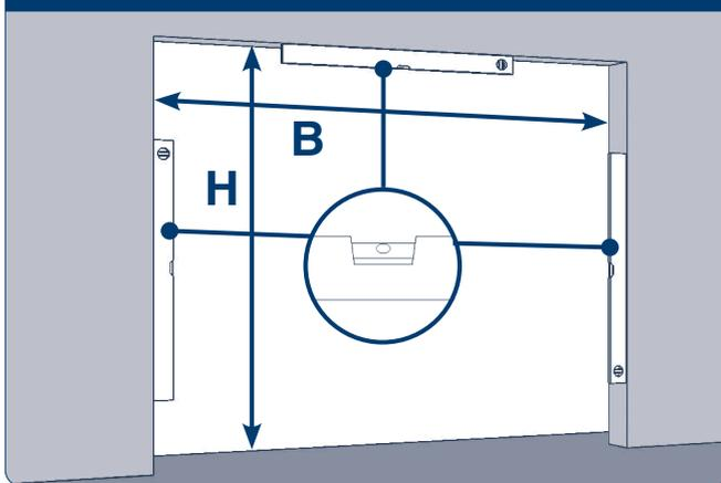
**H** — высота проема (расстояние от пола до верха проема)  $\pm 3$  мм.
